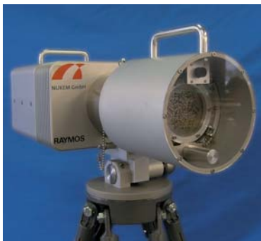
Mobile Kamera mit speziellem Kollimatorsystem zur Optimierung der Messzeit bei geringer Strahlung.
