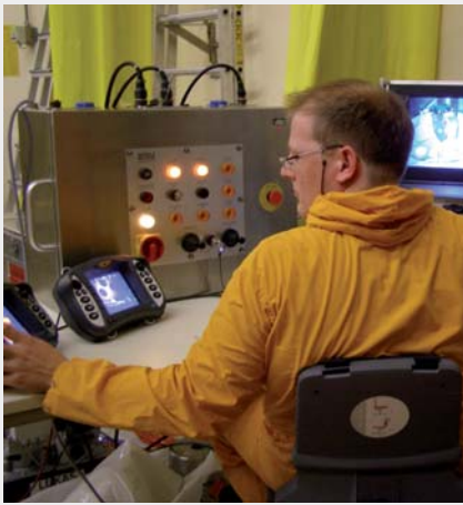
Steuerung von Greifer und Kamera
