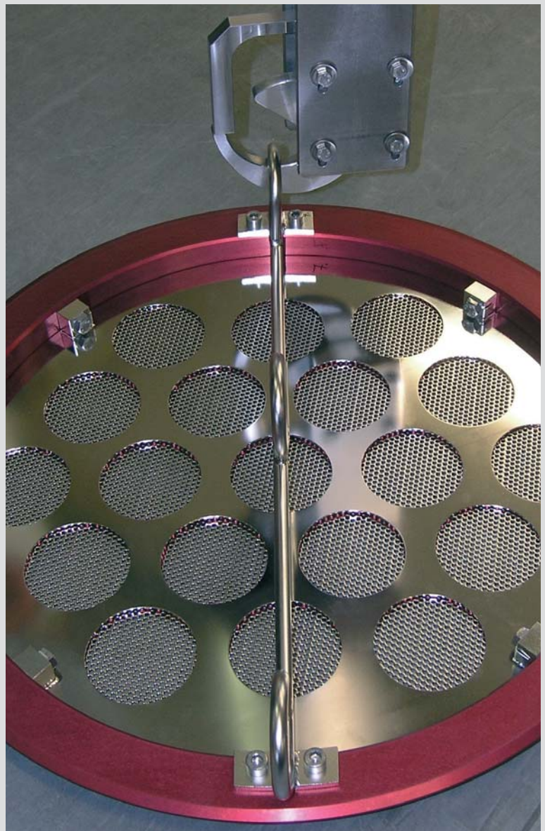
Der Höfer & Bechtel Setzmanipulator. Beim Setzen und Entnehmen der Abdecksiebe der Axialpumpen wird das Sieb an zwei verriegelbare Haken angehängt.
